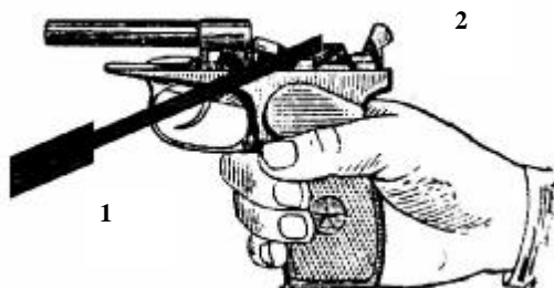
Рис. 1. Тензометрическая методика для исследования точности воспроизведения усилий, прилагаемых к оружию (1-тензометрическая консоль, 2- пистолет).
