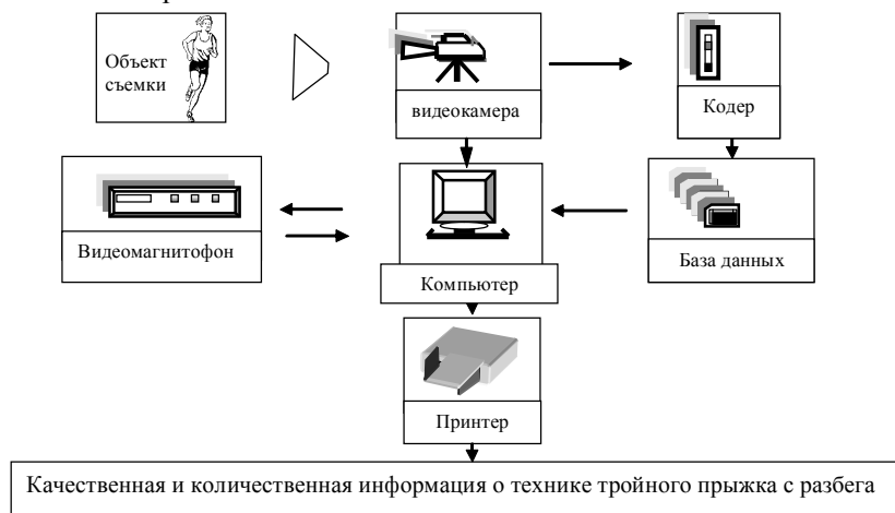
Рис 1. Блок-схема видеокomпьютерного анализатора движений «АСОВ»
